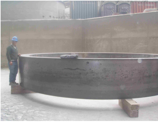
Llanta del horno, en el sitio de trabajo Fuente: P8293572.JPG
